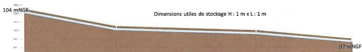
Figure 29 : Profil en long estimatif – Canal des Arrosants
