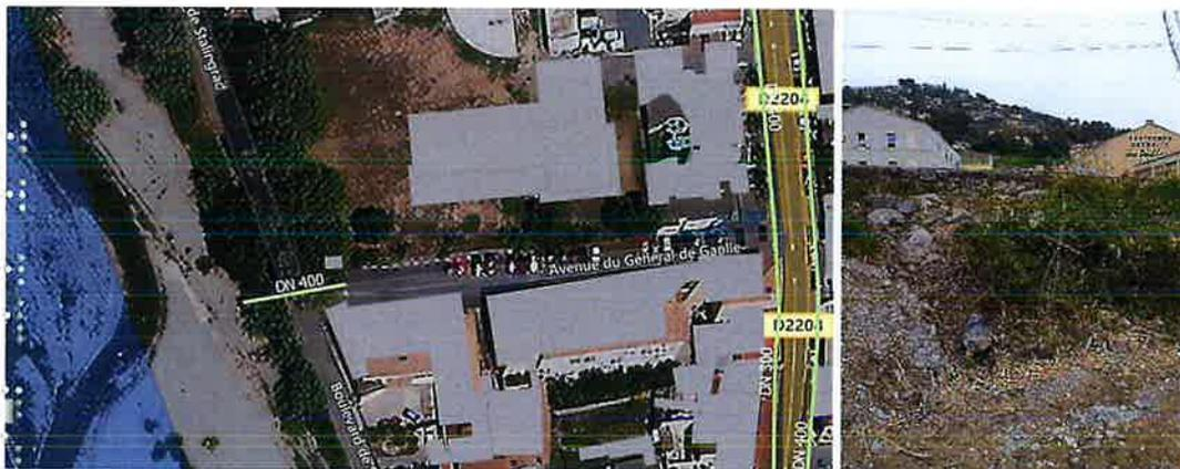
L'exutoire n°4 est le rejet en DN400 de l'école. Un clapet anti-retour a été mis en place à l'arrivée dans le Paillon.
